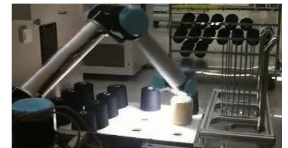
在捻线和摇纱工序，结合移动机械臂，完成上纱和下纱作业。
