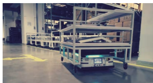
医疗器械制造 AMR结合不同适配治具实现各零件在多产线间的柔性转运。
