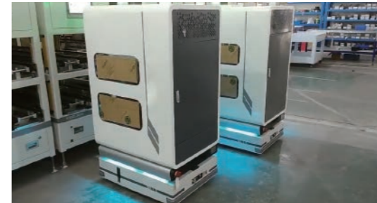
知名光伏电池片生产企业制造物流转型升级项目 为用户量身定制的精密双排双层的皮带输送线机构载具，准确、高效地完成晶圆料盒的叉取、配送，同步实现±2mm的物料对接放置要求。
