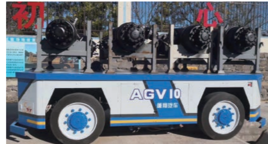
某汽配制造企业桥壳装配工序智能化转运 实现桥壳下线到装配环节的自主转运。
