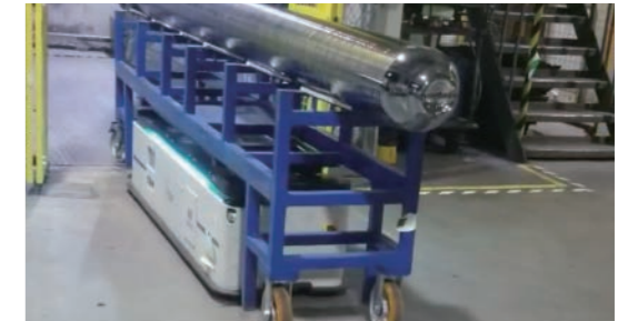
光伏原材料制造工厂物流智能化自动化转运 完成硅原料(毛棒)从2F拉晶炉到1F切断机的无人化自动搬运，目前小车每天搬运量数百趟，降低了人工成本，有效降低了事故发生。
