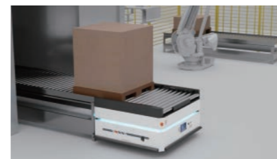
高精度自动上下料 支持±2mm/0.2°对接作业
