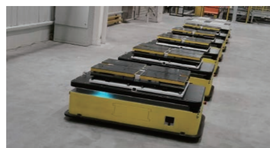
电气设备行业智能制造数字化工厂项目 迦智全向重载AMR、智能无人叉车分别与立库、升降机、产线等不同第三方设备对接，实现电磁线、模具、线圈等不同物料在不同工序间的柔性转运。
