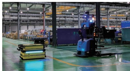
智能配电设备绿色数字化生产基地建设项目 5万平方米厂区内全部立库与线边库之间的多形制多重物料柔性转运，并与现场码头状态、RGV机器人、桁架虚拟门开关和叉车接驳台等第三方设备对接，要求多车型多设备调度总控，实现整场物流数字化。
